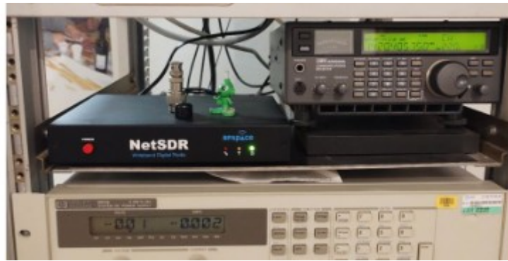
Fig.2 Il cuore pulsante del ricevitore , il multibanda AoR 5000,made in Japan
